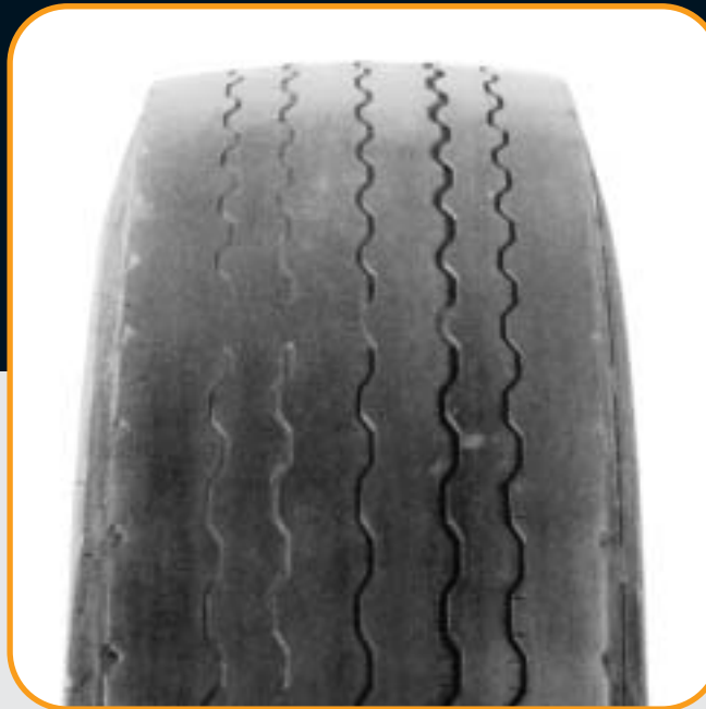
Nadměrné jednostranné opotřebení • Abnormal one-sided tyre wear • Чрезмерный односторонний износ
